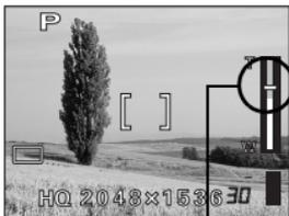
变焦指示上的游标根据变焦倍率上下移动。
