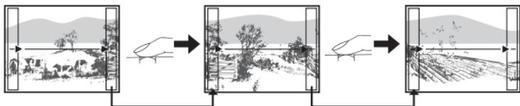
拍摄时，务必使图像的边缘（右/左/上/下）重叠，以便使 CAMEDIA Master 软件能够正确连接图像。
