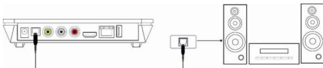
光纖端子輸出模式：使用光纖端子輸出方式時，用光纖信號線接入產品的光纖輸出介面和具有光纖輸入介面的音響設備，那麼就可以通過光纖輸出模式，輸出數位音頻信號進行外部解碼，實現杜比 5.1 聲道的高保真音效了。
