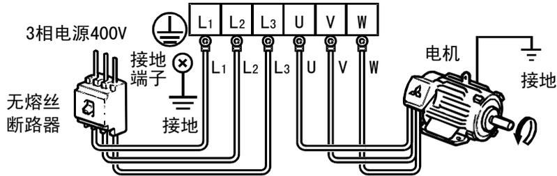
电源线必须接L<sub>1</sub>, L<sub>2</sub>, L<sub>3</sub>。
