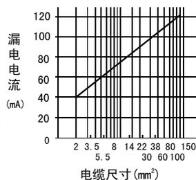
3相感应电机工频电源运行时的漏电流 (全闭外扇形电机400V60Hz)
