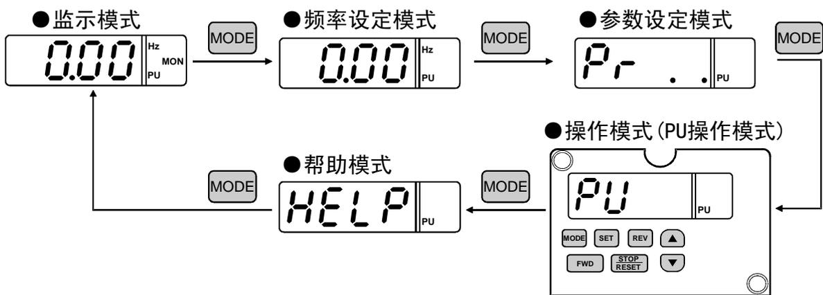
确认PU操作模式 (  $\boxed{PU}$  )。点动操作模式 (  $\boxed{JOG}$  ) 或外部操作模式 (  $\boxed{OPNd}$  ) 时, 用  $\blacktriangle/\blacktriangledown$  键设定为 (  $\boxed{PU}$  )。外部操作模式 (  $\boxed{OPNd}$  ) 状态下, 用  $\blacktriangle/\blacktriangledown$  键不能变成 (  $\boxed{PU}$  ) (Pr. 79) “操作模式选择”时, 请按照方法②将 (Pr. 79) “操作模式选择”设定为“1”。
