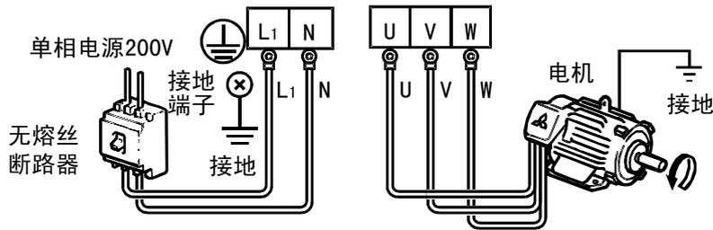
(注) 1. 为安全起见, 输入电源通过电磁接触器及漏电断电器或无熔丝断路器与接头相连。电源的开关用电磁接触器实施。
