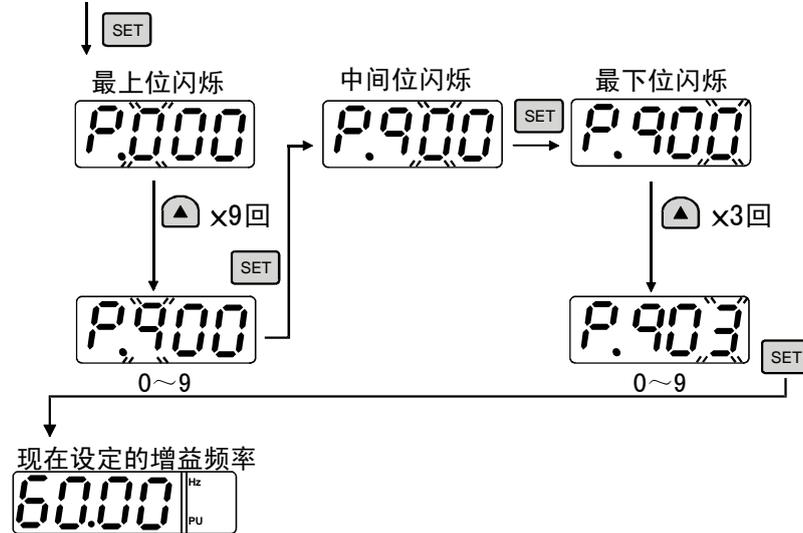
(4) 在Pr. 903设定增益频率, 端子2-5间的模拟电压A/D值用%表示。(80Hz时)
