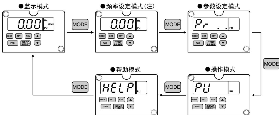
(注) 频率设定模式，仅在操作模式为PU操作模式时显示。
