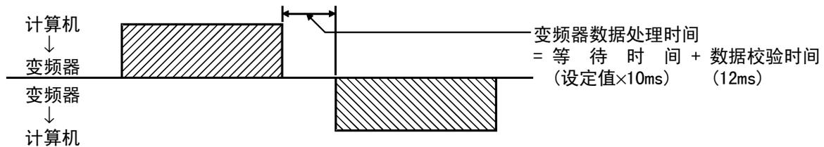
(注) Pr. 123“响应时间设定”不设定为9999的情况下，数据格式的“响应时间”没有，请作成通讯请求数据。(字符数减少1个。)
