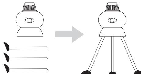
2、先把下支撑管装上放水盖，再把下支撑管的丝牙部分对准主机出风口上的螺母，按顺时针方向拧进螺母，并拧紧。（图示）
