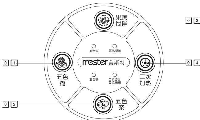
①②操作面板，初次通电，蜂鸣一声，所有指示灯齐亮，证明已通电，此时可以选择相应功能，3秒后开始进入工作状态，所选的功能相应的指示灯齐亮，不闪动，工作完成后，音乐提示，并指示灯闪动。
