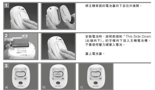
插上變壓器並開始充電,直到電池電力指示燈顯示四個橫條並停止閃爍為止 a)。(這項操作可能 會進行長達 20 個小時) 在您首次充電或每次取下電池後,顯示器會顯示「BATT」b)。可一邊充 電,一邊使用吸乳器。請勿在完成充電之前拔除變壓器 c)。 請避免將電池取下。如果取下電池,電池指示燈將會重新設定。必須讓電池放電長達 20 小時, 並再次充電 4 小時,以重新調整電池指示燈。
