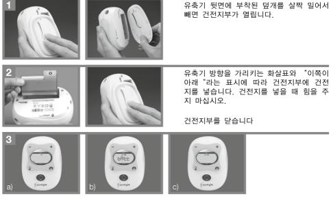
배터리 전원 표시등에 4개의 막대가 표시되고 깜박임이 정지할 때까지 전원 어댑터 플러그를 연결해 충전하십시오 a). (이러한 작동으로 최대 20시간 지속될 수 있음) **배터리를 처음 충전할 때 또는 배터리를 매번 분리한 후에는 표시창에 "BATT"로 표시됩니다 b).** 충전하는 동안 펌 프를 사용할 수 있습니다. 충전이 완료될 때까지 전원 어댑터 플러그를 분리하지 마십시오 c). 배터리를 분리하지 마십시오. 배터리를 분리하면 배터리 표시등이 재설정됩니다. 최대 20시간 까지 사용할 수 있으며 배터리 표시등을 재조정하려면 다시 4시간 동안 재충전해야 합니다.
