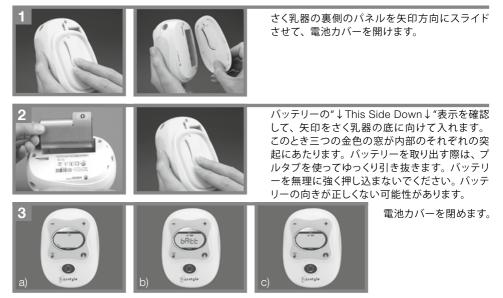
アダプターを差し込み、電源インジケータが4つの線を表示して点滅を停止するまで充電しますa)。(この動作は上限20時間続きます。) 初めて充電するときや、電池を外したときは、「BATT」と表示されますb)。 さく乳器は充電中でも使用することができます。充電が完了するまでアダプターを抜かないでくださいc)。 電池を取り除かないでください。電池を取り除くと、電源インジケータがリセットされます。電源インジケ ータを元に戻すには、20時間の放電と4時間の新規充電が必要になります。
