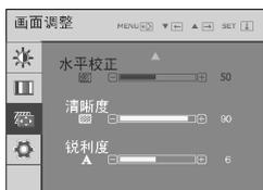
**水平校正** 减少画面背景上可见的竖直条纹或波纹,水平尺寸会发生改变。
