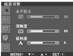
**水平校正** 减少画面背景上可见的竖直条纹或波纹,水平尺寸会发生改变。
