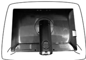
2. 将支架 (stand Base) 上的钩子对准显示器底座上相对应的插槽。
