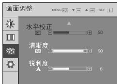
**水平校正** 减少画面背景上可见的竖直条纹或波纹,水平尺寸会发生改变。
