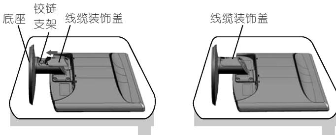
5. 安装完毕后，将显示器小心拿起并使其面向前方。
