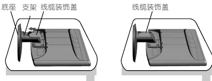
5. 安装完毕后，将显示器小心拿起并使其面向前方。
