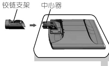
3. 按图示方向将底座装入铰链支架。
