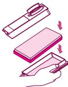
1 将电机保护过滤器装入过滤器外壳内。
