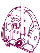
\* 如电源线不能完全收回机体内时，请按下载线器按钮，拉出一部分线后再重新收回。
