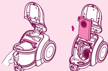
2 卸下集尘桶，从主机取出电机保护过滤器。
