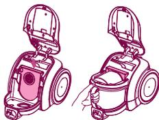
3 将组装好的过滤器插入过滤器安装部位后安装集尘桶。
