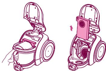
2 拆卸集尘桶后，从主机取出电机保护过滤器。
