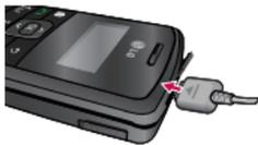
1. 如图所示，箭头面朝上，将电源适配器的插头推入手机右侧的插座，直到卡入到位。
