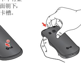
**警告:** 手机开机时,不要插入或取出存储卡。否则会损坏存储卡和手机,同时保存在存储卡上的数据也有可能受损。
