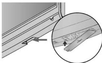
当壁式安装时, 需安装保护盖, 如图示那样将保护盖插入电视机中, 直至听到滴嗒声。
