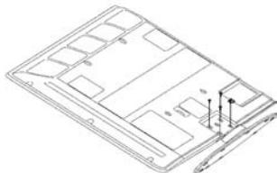
② 如图所示，将底座安装到电视机上。
