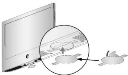
从保护盖上移除保护膜后, 像图示那样将其贴在电视机上。
