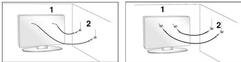
① 如图所示,采用吊环螺栓或电视机托架/螺栓将电视机固定在墙壁上。(如果插入吊环螺栓前,其位置上有其他螺栓,则先将其卸下。)
