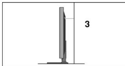
③ 采用稳固绳索(非随机附件,需另购)固定电视机。这样墙壁和电视机之间才能保持水平。
