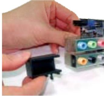
2. 將模組支架上的栓釘對準主機板上的安裝孔，然後置入安裝孔中，這時音效模組銲接面上的14-pin接頭也會插入主機板上的卡拉揚音效接頭(J7)。務必確認支架上的栓釘完全穿透安裝孔，牢牢地固定於主機板上。
