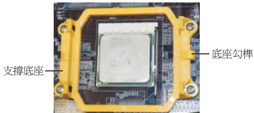
3. 請將散熱片置放於C P U 上。接著，將一邊彈夾上的固定孔穿過支撐底座上的底座勾榫以進行固定。按照同樣的方法固定好另一邊的彈夾。
