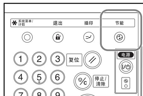
复印机将在 15 秒（对于 62 cpm 机型）或 18 秒（对于 82 cpm 机型）内准备复印。
