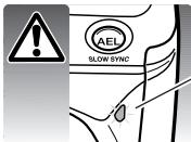
当数据读取指示灯亮着时，切勿将相机从计算机上断开，否则该数据或存储卡将有可能被永久性破坏。
