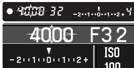
如果所需要的曝光值超出快门速度允许的范围，快门速度显示将闪烁。调整光圈值直到该显示稳定为止。
