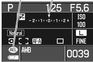
当显示屏和取景器的Ev刻度指示0时，则表示快门速度和光圈值显示中的锁定曝光值与点测光区域测定的曝光值相同。
