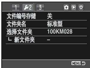
如果文件编号存储功能处在激活状态且更换了存储卡，如果新的存储卡内所有的文件编号都比最后存入前一张存储卡的文件编号小，则随后存入新存储卡的第一个文件编号比最后存入前一张存储卡的文件编号大1。如果新存储卡的最大文件编号比最后存入前一张存储卡的文件编号大，则随后存入新存储卡的第一个文件编号比该卡的最大文件编号大1。
