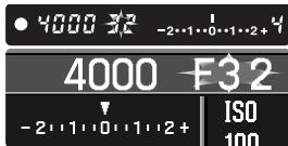
如果所需要的曝光值超出光圈值允许的范围，光圈值显示将闪烁。调整快门速度直到显示稳定为止。
