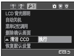
CCD暴露之前，将出现确认屏幕，选择“是”则打开快门和反光镜，选择“否”则取消清洁操作。
