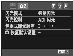
当自动对焦系统因某种原因无法正常对焦时，相机会自动从ADI测光切换到预闪光TTL。当使用微距双闪光灯2400、微距环形闪光灯1200、无线或离机闪光灯时，闪光控制将被设定为预闪光TTL。
