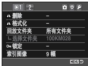
**所选择的图像**—删除多个图像。当选择该选项时，会显示一个图像选择屏幕(p.83)。使用十字键的左/右键来选择第一个想删除的图像。按十字键的向上键可在想要删除的图像上标上删除标志。若想取消对某图像的删除选择，先用黄色边框将它选中再按向下键；被标上的删除标志即会消失。重复上述操作直到所有想删除的图像都被标上垃圾箱图标为止。按十字键继续(将出现确认对话框)，或按菜单按钮取消操作并返回回放菜单。在确认屏幕上，选中“是”并确定，则删除被标上垃圾箱图标的图像。
