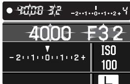
如果所需要的曝光值超出快门速度和光圈值允许的范围，快门速度和光圈值显示将闪烁。在明亮的照明条件下，请在镜头上使用中密度滤镜、设定较低的相机感光度(ISO)或使用人工照明，以降低照明强度。在低照明条件下，请使用内置闪光灯或增大相机的感光度(ISO)。
