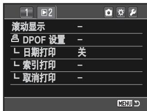
**所选择的图像**—用来选择需要打印输出的图像，或打印份数各不同的一组图像。选择该选项时，会出现一个图像选择对话框 (p.83)。使用十字键的左/右键来选择需要打印输出的图像。按十字键的向上键在需要打印输出的图像上标上打印机图标。打印机图标旁的数字表示该图像将要打印的份数。按向上键则增大打印份数，按向下键则减少打印份数。最多可指定打印九份。要取消某图像的打印选择，按向下键直到打印份数减到零即可，这时附在图像上的打印机图标会消失。重复上述操作直到所有需要打印的图像都被标上打印机图标为止。按十字键则创建DPOF文件，按菜单按钮取消创建打印文件的操作，并返回回放菜单。
