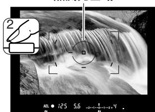
一边按住AE锁定，一边将拍摄对象置于对焦框内，然后半按快门释放按钮进行对焦(2)。将快门释放按钮按到底完成照片拍摄。
