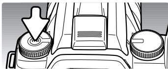
白平衡可相对某光源的已知色温进行设定，也可相对色度计决定的色温进行设定。将白平衡拨盘转到色温(K)位置，按白平衡按钮打开设置屏幕。
