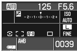
相机内装有电量自动显示器。相机打开后，在其显示屏上会显示电量状态。当电池剩余电量太低时，指示图标就会从白色变成红色。若电池电量太低，将无法使用全部功能。如果显示屏呈现一片空白，表示电池可能已耗尽。
