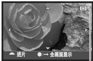
用十字键的四个方向键可滚动显示放大的区域。定位图标(1)指示当前所显示图像属于整个图像的哪一部分。放大按钮和缩小按钮可用来改变放大倍数。
