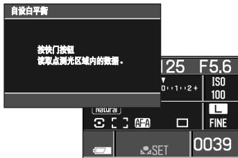
将出现指示信息。半按快门释放按钮时，显示器的显示将返回。红色的自定义设置图标将显示在白平衡栏中。将白平衡拨盘转到另一位置以取消程序。
