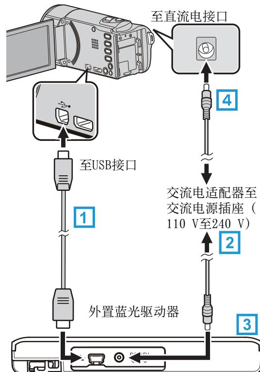
① 将 BD 刻录机(外置蓝光驱动器)的 USB 电缆连接至本机。
