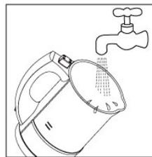
3. 杯体：请用水轻轻洗去杯体内部粘附的豆浆或其他东西，切勿将杯体浸入水中，也不要用水清洗杯体外侧，以防止杯体上的耦合器、插座或者内部进水，发生短路现象。
