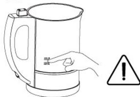
1. 杯体上的插座、耦合器，机头上的耦合器上壳请勿进水，如果进水，必须擦干后才能使用。
