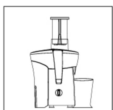
11. 用推料棒缓慢地将食材由进料口推入，不要用太大的力压推料棒，以免影响榨汁效果。
