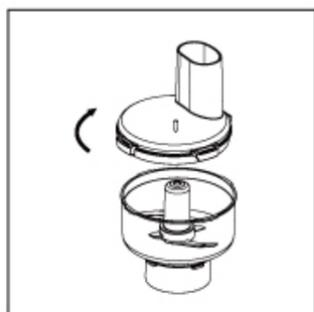
2. 将绞肉杯盖的触针插入绞肉刀架中，盖上杯盖，并将卡扣旋紧。
