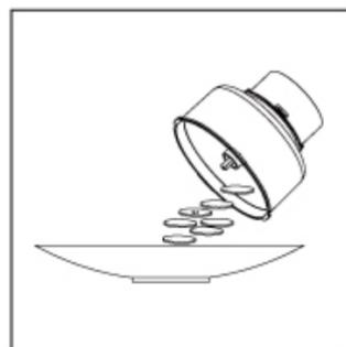
5. 加工完成后，断开电源，将杯体从主体上卸下，用手往下微压同时旋开绞肉杯盖，取出切丝切片刀，再取出食材。
