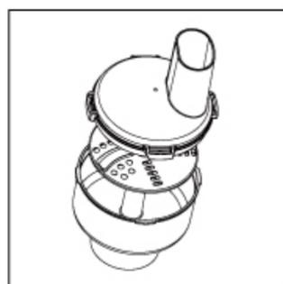
2. 将绞肉杯盖的触针插入切丝切片刀中，盖上绞肉杯盖，并将卡扣旋紧。
