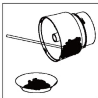
5. 加工完成后，断开电源，将绞肉杯从主体上卸下，用手往下微压同时旋开绞肉杯盖，取出绞肉刀架，再取出食材。
