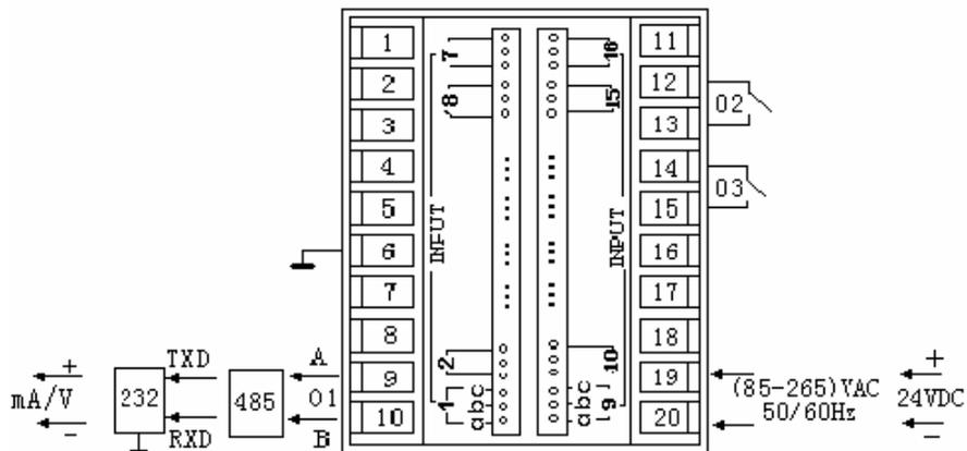
3) 8路巡检仪表接线图—(96×96×112) mm
