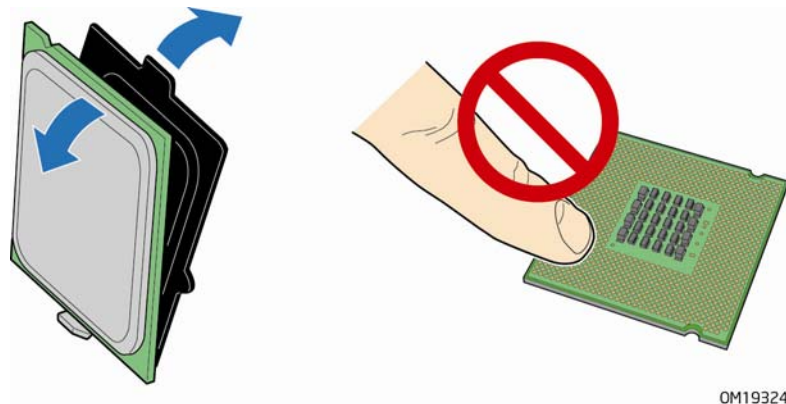
图 9. 从处理器保护罩中取出处理器
