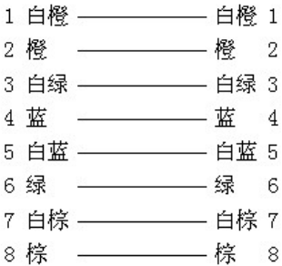
图 2-4. 直通线两端对应关系
