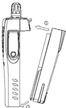
要卸下电池时,请先确认对讲机已关机,然后将对讲机电池上面的卡扣向上推,再从对讲机中取出电池上部,并将电池取下。(见图②)
