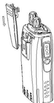
要卸下皮带夹时，用手压皮带夹的拆卸擎直到它松开，然后向上将皮带夹取出。(见图⑥)
