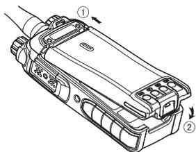
如需卸下电池，请先关闭对讲机。然后将底部电池推钮往上推起，并取出电池。
