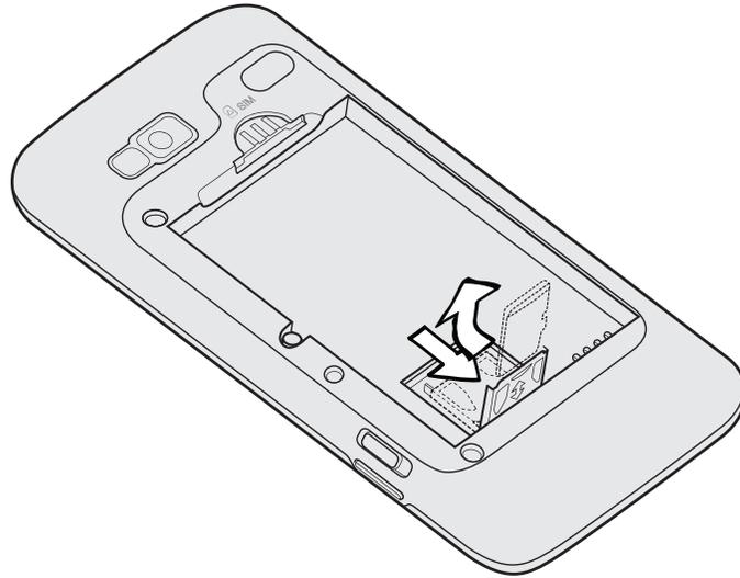
4. 將記憶卡金屬接點部分朝向插槽內的接點，然後將儲存卡推入固定座。
