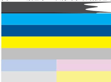
图 12-3 颜色条 - 颜色混合（黄色条中出现品红色条纹）
