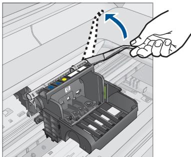
5. 通过将打印头垂直提起取出打印头。
