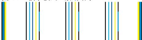
如果线条参差不齐则校准打印机，然后重新打印诊断页。
