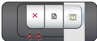
左侧打印墨盒指示灯表示彩色打印墨盒的状态；右侧打印墨盒指示灯表示黑色或照相打印墨盒的状态。
