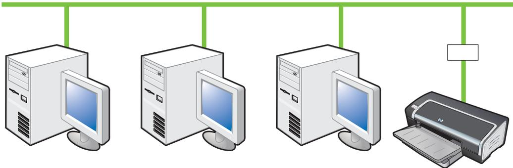
可以通过可选用的 HP Jetdirect 外置打印服务器将打印机直接连接至网络，从而在网络环境共享打印机。此配置提供的性能优于直接通过计算机进行打印的性能，同时可以灵活放置打印机，并且让 Windows 和 Macintosh 用户都能共享打印机。
