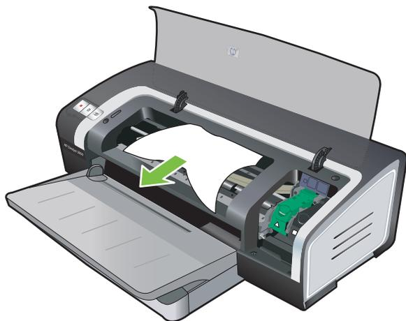
清除卡纸后，关闭所有机盖，开启打印机（若已关闭），然后按**继续**按钮。打印机将从下一页继续打印作业。需要重新发送出现卡纸的那几页文件。
