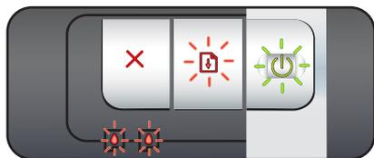
重新初始化打印机后，打印机指示灯循环亮起。
