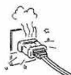
**2** 電源線有無破裂或損傷？
