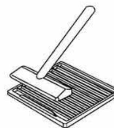
**3** 清洗完成後，將空氣過濾網裝回機體上即完成清洗工作。
