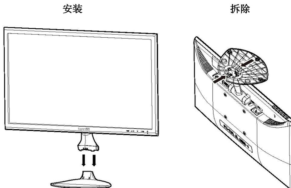
图一. 安装和拆除底座
