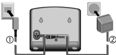
如图所示，分别用电话线1与电源线2将电话插孔和电源装置（220V）与基座相连接。将电话线与电源线放到电缆凹槽中，并务必使之一直插在基座上。
