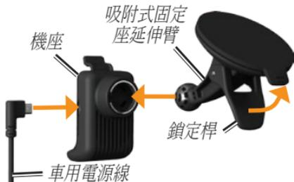
5. 將鎖定桿向後朝擋風玻璃方向按壓。
