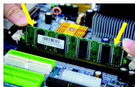
圖 1. 記憶體模組有一個凹痕，所以只能以一個方向插入。請扳開記憶體模組插槽卡榫，以雙手按在記憶體模組上邊兩側，以垂直向下平均施力的方式，將記憶體模組下壓推入插槽。
