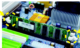
圖 2. 一旦確實壓入插槽內，兩旁的卡榫便會自動向內卡住記憶體模組予以固定。試著輕輕搖動記憶體模組，若不搖晃則表示安裝完成。
