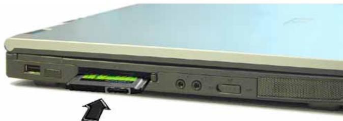
1. 請依據卡片上的符號，正面朝上將卡片插入擴充槽內。插入卡片前，可能需要先將鎖門就定位。
