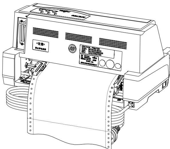
5) 按下【装纸/卸纸】键，纸张将自动送到打印位置。
