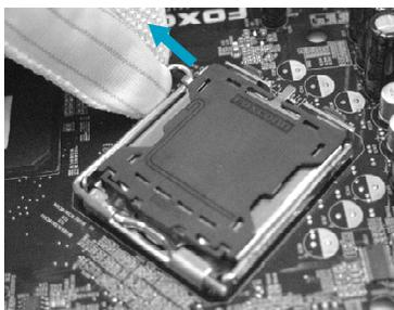
2. 按住承载盘后部的小突起, 使承载盘前端微微翘起, 用拇指将承载盘打开。小心不要触摸到插座的针脚。
