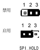
**SPI\_WP Jumper: SPI\_WP (仅在安装了SPI flash的主板上适用)**
