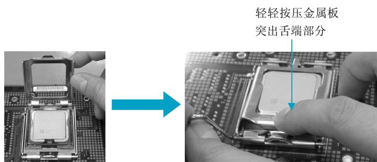
7. 将固定拉杆放低归位以锁定 CPU。
