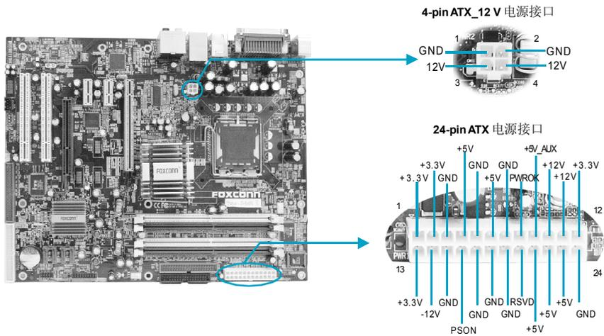
4-pin ATX\_12V 电源接口
