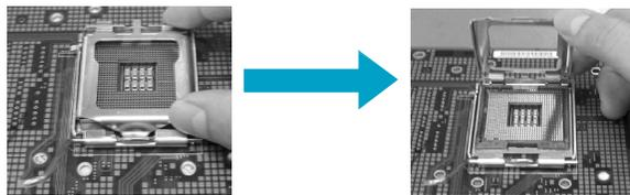
5. 由于底座触点设计为钩形，所以在安装CPU时，应将CPU倾斜至一定角度，然后将CPU上的三角标记与CPU的底座缺角（如下图中Pin1位置所示）对齐。最后将CPU轻轻地安装在插座中。
