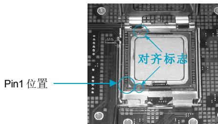
6. 闭合固定金属板, 然后将金属板舌端部分往下压。
