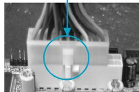
**注意：**强烈推荐您使用 24-pin 的电源线。如果您要使用 20-pin 的电源线，请按照右图所示方法连接 ATX 电源接口。
