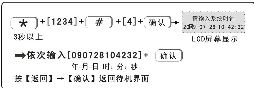
注：此时[查询]键和[旁路]键为 向左向右功能，使光标移动到所需修改的位置，输入正确数字覆盖掉原来数字即可。输入完毕后，[确认]存储自动并返回上一级菜单。
