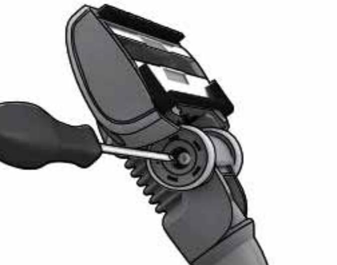
3. 旋松轮轴, 清洁所有部件。按与拆卸相反的顺序将它们重新组装在一起。
