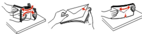
**注意：**扇形展开信封能防止信封边缘粘连在一起。这样也有助于正确送入信封并避免卡纸。不要折叠或弄皱信封。
