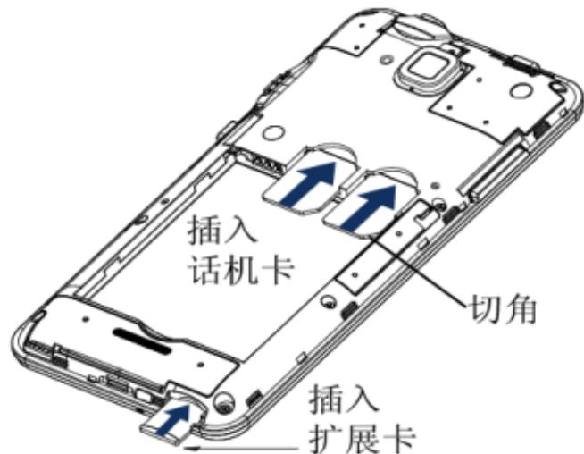
2. 手机卡卡槽区分 C 网和 G 网，需按照底壳上的标识正确放卡。
