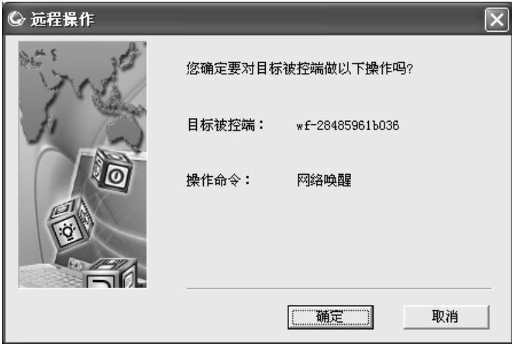
网络唤醒功能必须打开 BIOS 电源管理设置（Power Management Setup）中的相关参数，比如 Power On by PCI Card 设置为 Enabled；WOL（pme#）from soft—off 设置为 Enabled（不同主板描述不一定相同）。
