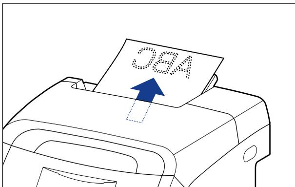
将 Legal 尺寸的纸张输出到出纸托盘时，请拉出辅助托盘以防止纸张从出纸托盘中伸出。使用辅助托盘时，请向外将其拉出直到停止。
