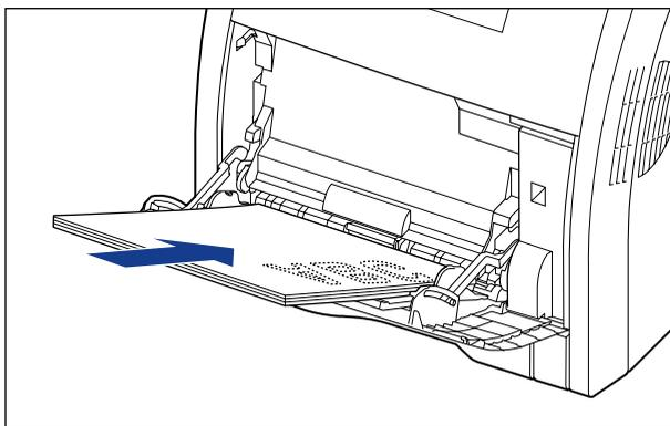
**7** 将纸张导板与纸叠的两侧对齐。
