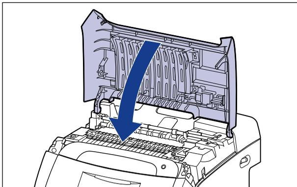
如果指示顶盖内部出现卡纸的消息在顶盖关闭后仍留在打印机状态窗口中，则说明卡纸仍留在定影单元中。请按照“指示卡纸的消息没有消失”（请参阅第 7—21 页）中的步骤取出卡纸。
