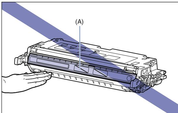
**8** 如图所示，用手指钩住拉环，取下包装材料。
