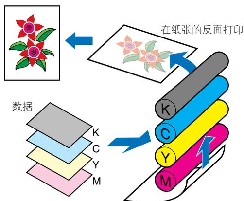
接着，将所有四种颜色的数据传送到纸张上，纸张通过定影单元并从打印机中输出。
