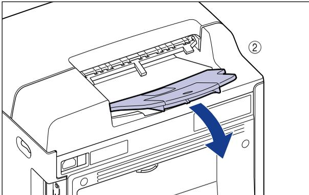
安装出纸托盘，直至听到“咔嗒”声，以便按下图所示将背面的 (A) 钩在打印机的 (B) 上。
