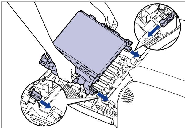
确保打印机上的三角形标记对齐双面组件上的三角形标记，如图所示。
